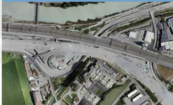
Der Vollanschluss Visp West gewinnt durch die fertig erstellten Kunstbauten und die Schüttungen des Trassees zwischen der Losgrenze zum Gedeckten Einschnitt Raron und dem Tunnel Visp beim Schwarzen Graben deutlich an Kontur.
