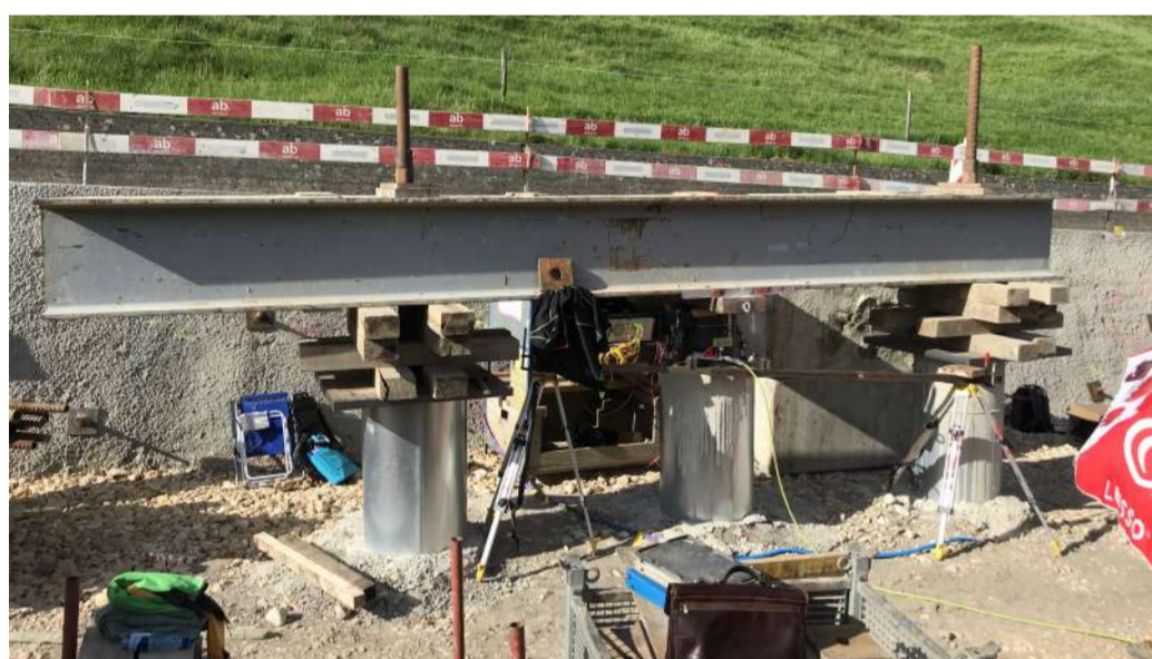
Abb. 3: Sicht des Pfahlversuches im Feld
